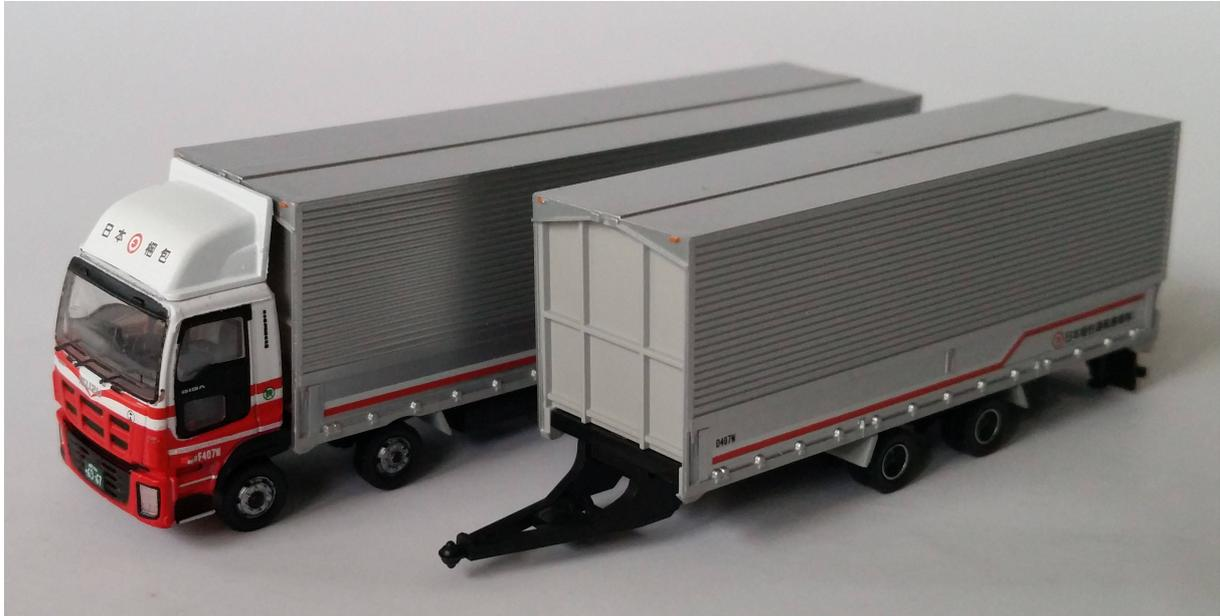
*Der Hängerzug mit Tandem Anhänger, kurzem Führerhaus und Windabweiser*
