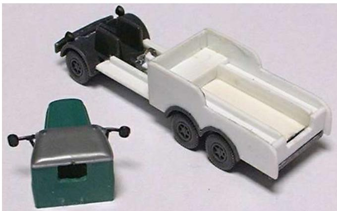
Nun wurden die Fahrzeugteile zur Lackierung vorbereitet. Dazu werden z.B. die Räder mit Tesafilm abgeklebt. Als Grundfarbe habe ich mir ein Mattes Rehbraun ausgewählt. Nach dem trocknen der Farbe wird der neue Kühlergrill aus perforierter Aluminiumfolie eingesetzt und das Fahrzeug zusammen gefügt. Die Radkappen der Bereifung wurden silbern bemalt und die Radnaben rot markiert. Scheinwerfer, Rücklichter, Blinker und Spiegel wurden auch farblich abgesetzt.
