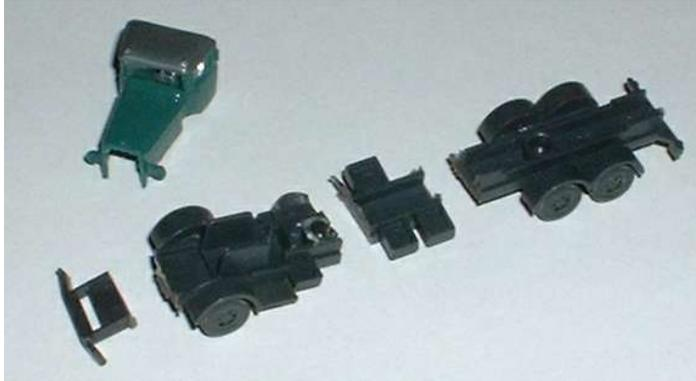
Das Karosserieteil mit der Fahrerkabine wurde nun einer Modifikation unterzogen. Die Scheinwerfer, der Stern auf dem Kühler und die Blinker auf dem Dach wurden entfernt. Der Kühler wurde vorsichtig ausgeschnitten und ein Heckfenster wurde zusätzlich angebracht. Mit Hilfe von Plastruct- Profilen wird das verkürzte Fahrgestell wieder zusammen gefügt und die Fahrerkabine angepasst.
